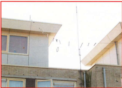
De gehele antenne opgehangen als "sloper".
